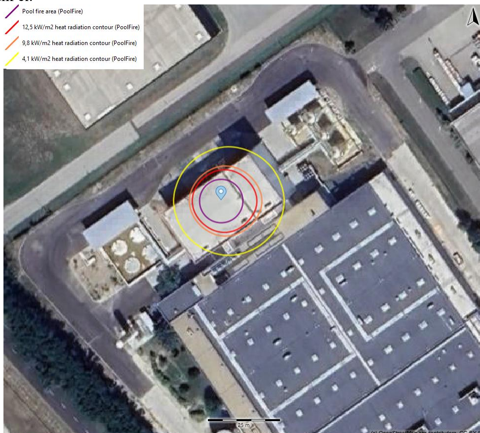
18. ábra: Veszélyes anyagot tartalmazó csővezeték törése- Tócsatűz
