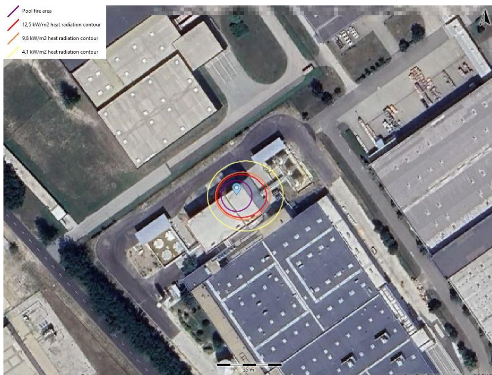
20. ábra – A LiPF6 oldat belső tartályok kármentőjében keletkező tócsatűz hőhatása
