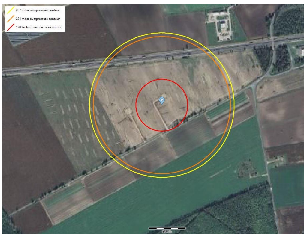
3. ábra: A cseppfolyós oxigéntartály robbanásának övezetei
